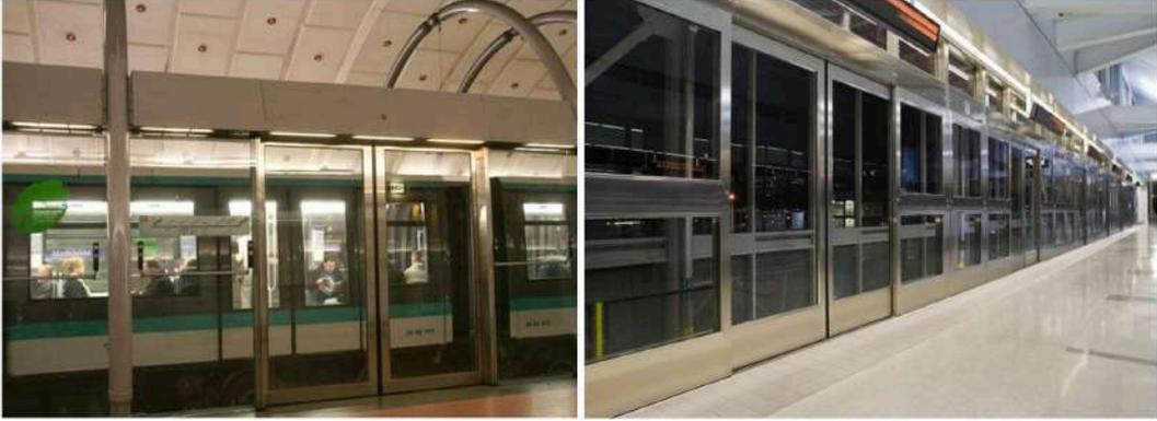
Gambar 1. Platform Screen Door (PSD) sebagai pintu pemisah dan pengaman antara kereta bawah tanah dengan platform stasiun
